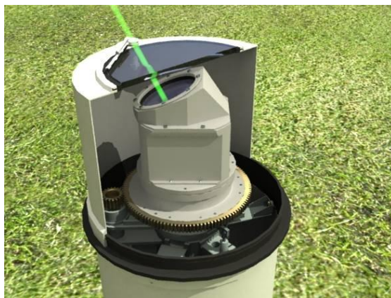
Рис. 15. Доплеровский лазерный измеритель вертикального профиля ветра [19, с.21].
