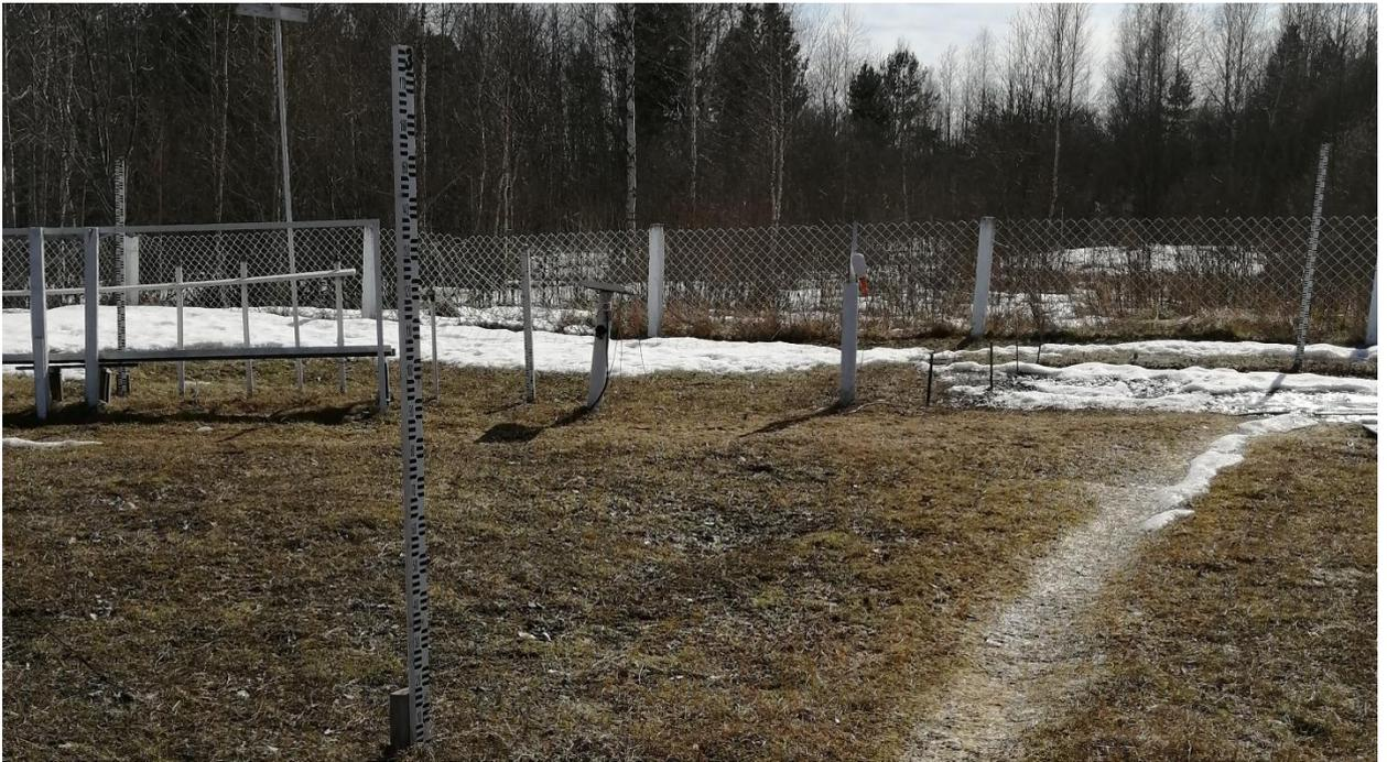
Рис. 1.12. Три снегомерных рейки (которые устанавливаются перед установлением снежного покрова и убираются после его схода)
