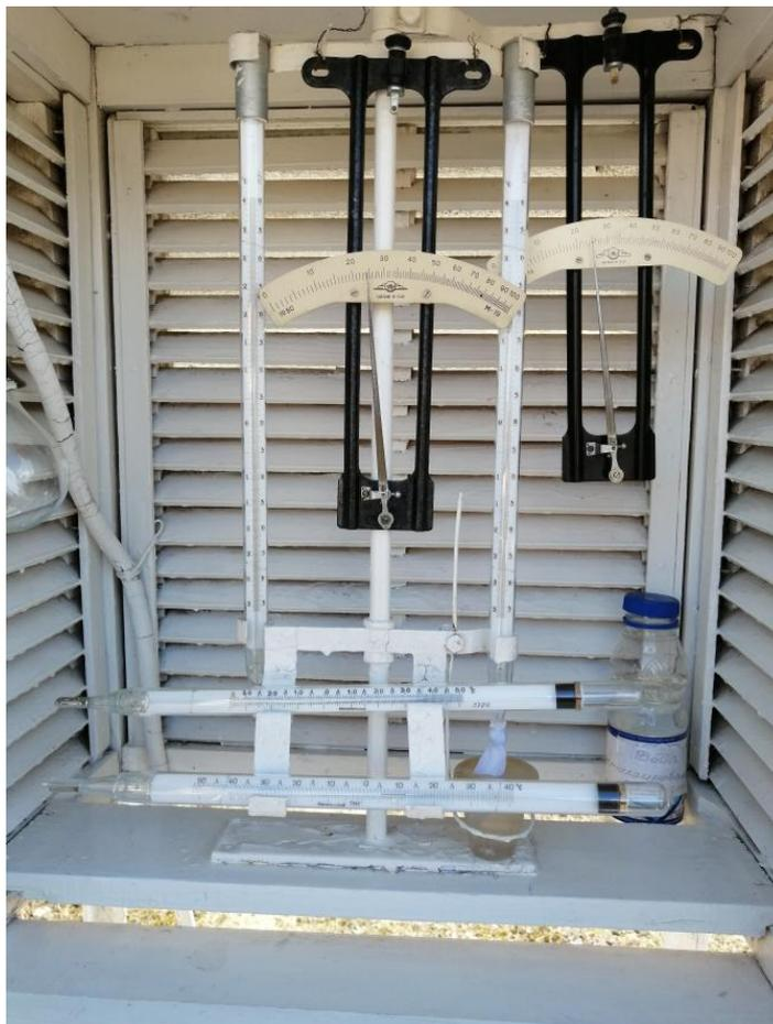
Рис. 1.10 Психрометрическая будка с установленными приборами (психрометр, максимальный и минимальный термометры, гигрометры)
