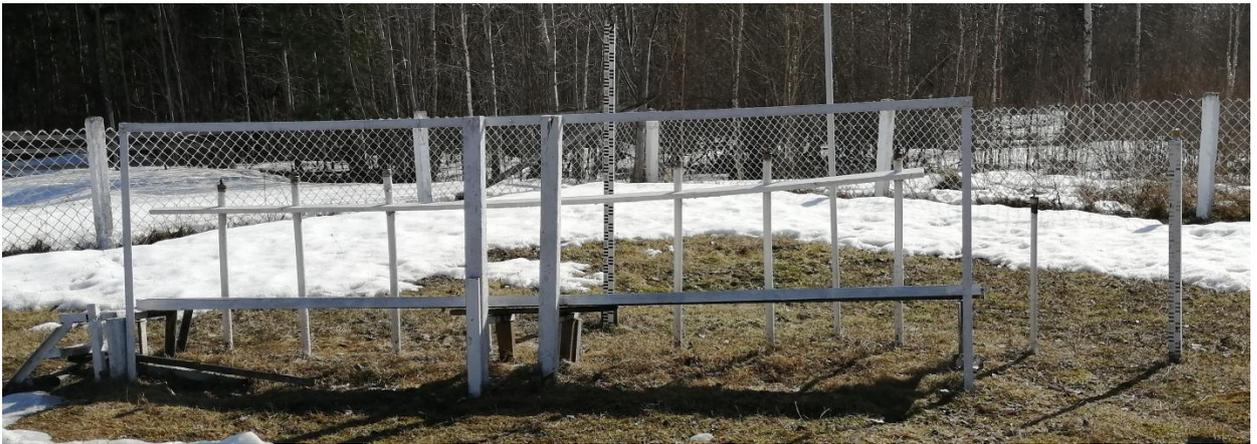
Рис. 1.14. Участок с естественным растительным покровом, где установлены почвенно-глубинные термометры и мерзлотомеры
