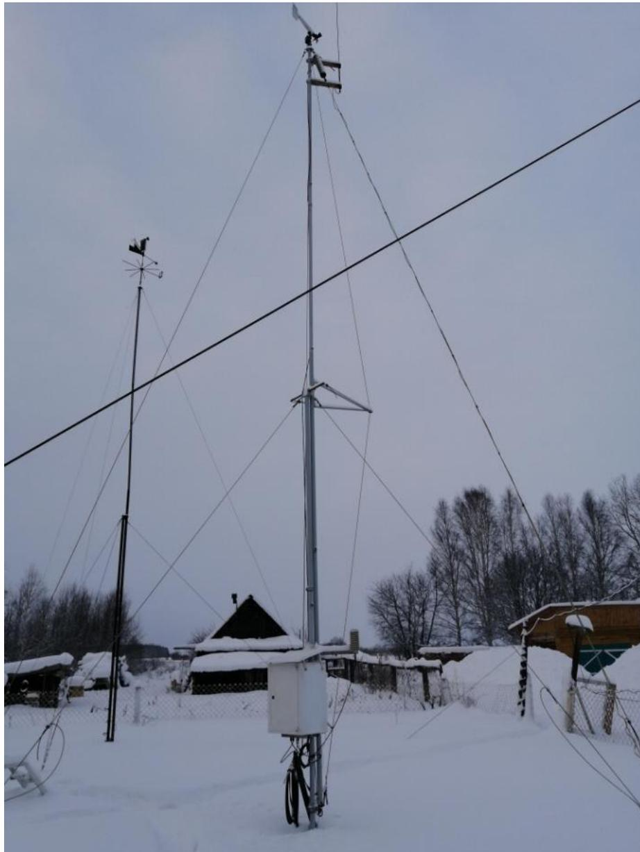
Рис. 1.17. Автоматизированный метеорологический комплекс (АМК) с датчиком температуры и влажности воздуха , направлением и скоростью ветра.
