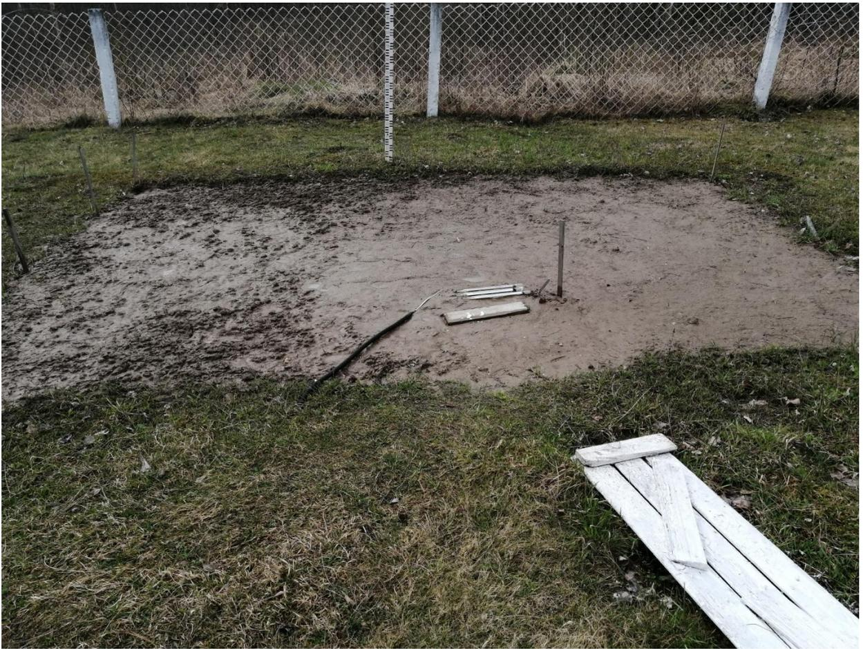
Рис. 1.13. Оголенный участок с напочвенными термометрами и датчиком температуры подстилающей поверхности
