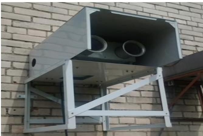
Рисунок 5.8. Размещение прибора для измерения полярных электрических проводимостей на сети атмосферно-электрических станций (п. Воейково).
