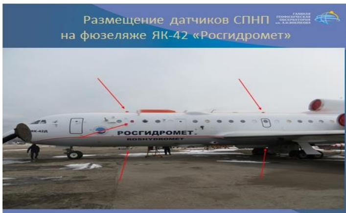
Рисунок 5.10. Размещение датчиков приборов для измерения напряженности электрического поля (СПНП) на фюзеляже самолета-метеолaborатории ЯК-42 «Росгидромет».
