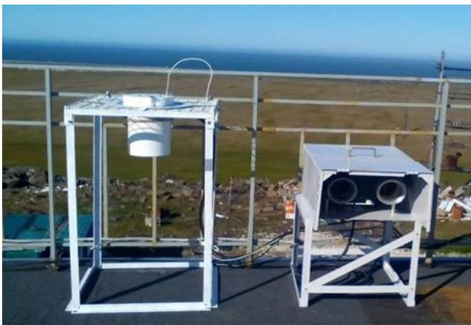
Рисунок 5.9. Размещение приборов для измерения напряженности электрического поля и полярных электрических проводимостей на сети атмосферно-электрических станций (п. Тикси).
