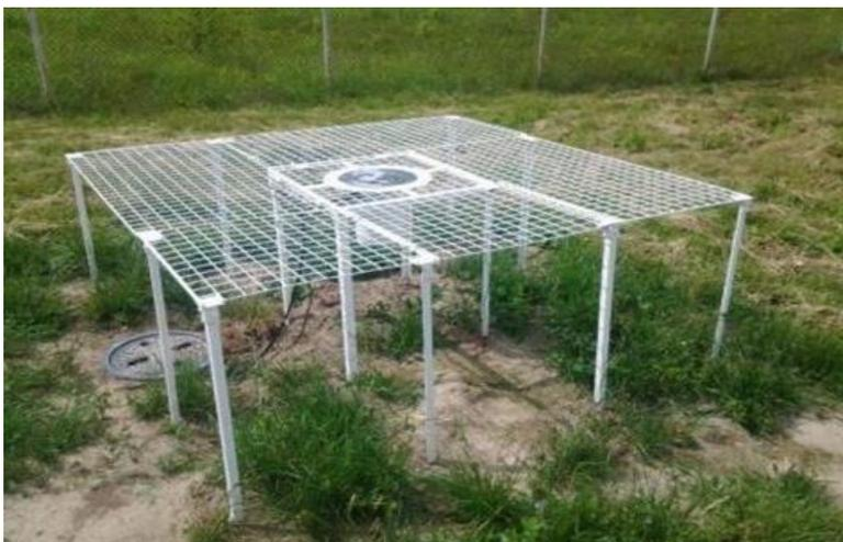
Рисунок 5.7. Размещение прибора для измерения напряженности электрического поля на сети атмосферно-электрических станций (п. Воейково).
