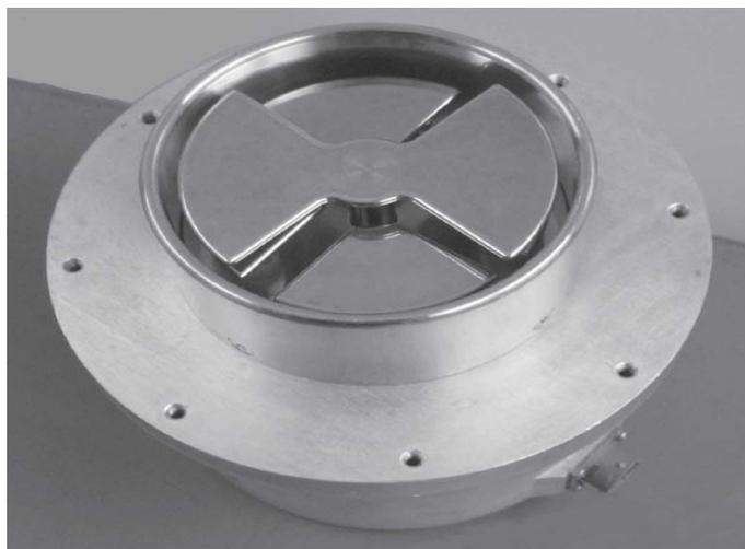
Рисунок 5.6. Внешний вид самолетного измерителя напряженности электрического поля конструкции NASA
