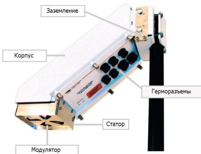
Рисунок 5.5. Внешний вид прибора CS110.
