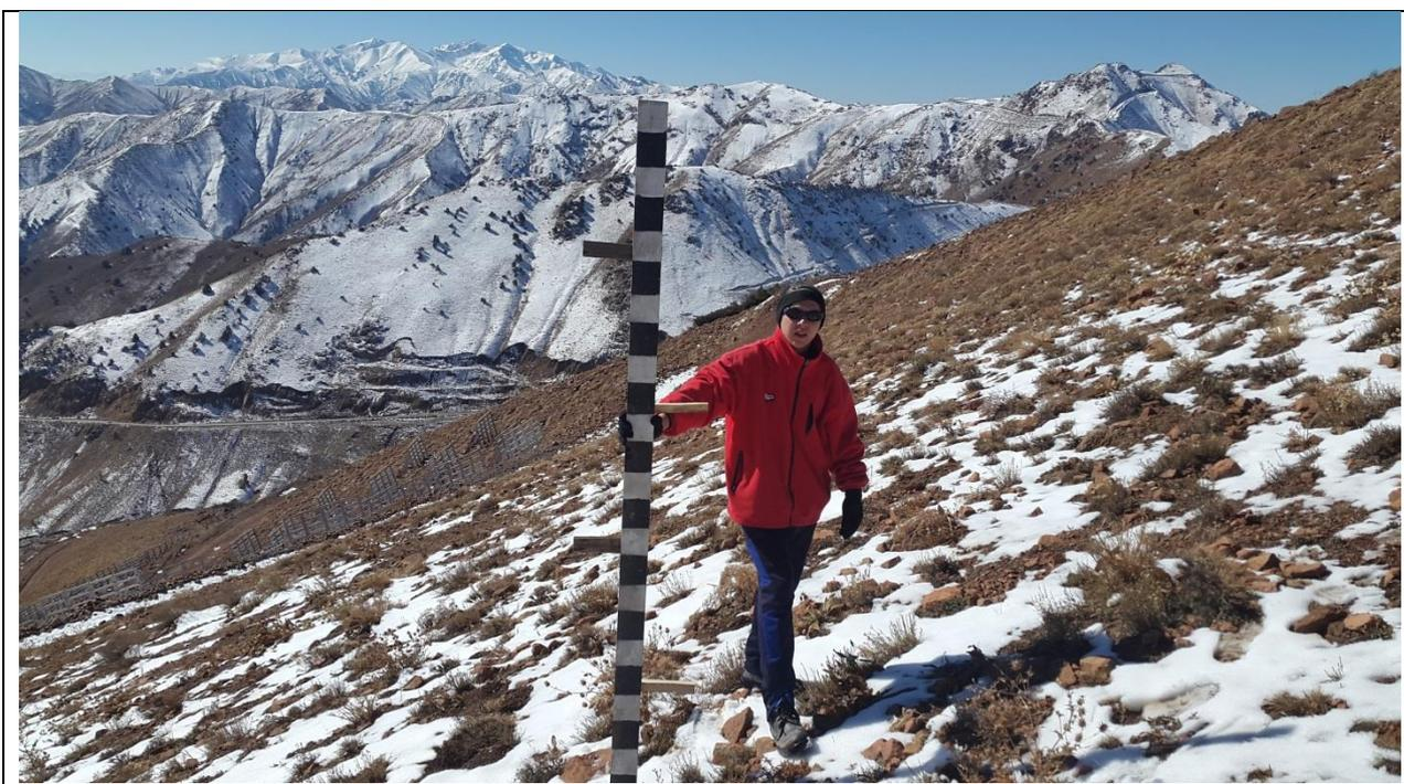
Рисунок №5 Установка снегомерной рейки на лавиносборе.
