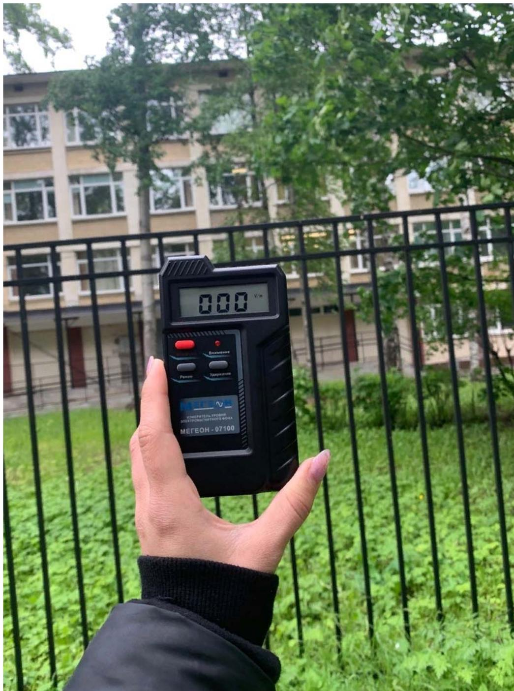
Рисунок 3.1 – Прибор измеритель электромагнитного и магнитного поля «Мегеон 07100». Измерения на станции № 40
