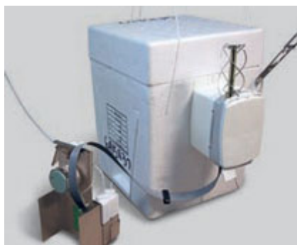
Рисунок 1.5 – Цифровой радиозонд Vaisala RS92.
