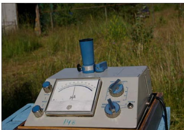
Рисунок 1.8 – Измерение содержания озона по зениту в пасмурную погоду (фото взято из интернета)
