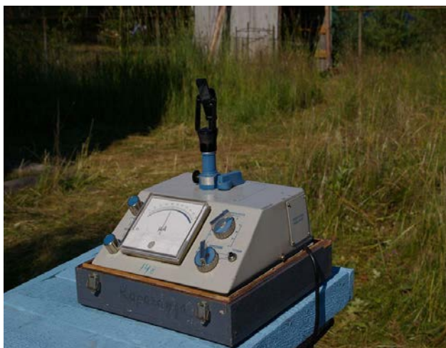
Рисунок 1.7 – Озонометр М-124 в рабочем состоянии. Измерение содержания озона по Солнцу в солнечную погоду (фото взято из интернета)
