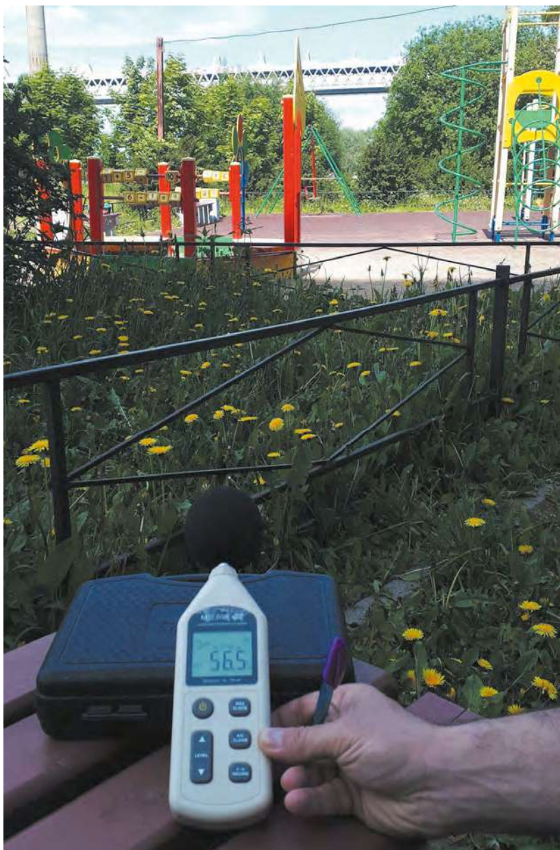
Рис. 1.4. Цифровой анализатор уровня шума «Мегеон 92132». (Измерения на Канонерском острове в Санкт-Петербурге. Фото Лисовского А.Я.).
