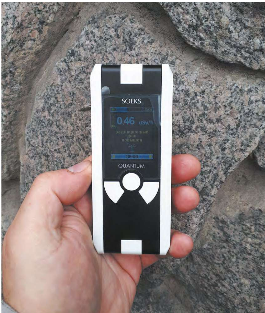
Рис. 4.2. Дозиметр «Соектс-Квантум» при измерениях природной радиоактивности гранитов. (г. Выборг, фото Дроздова В.В.).
