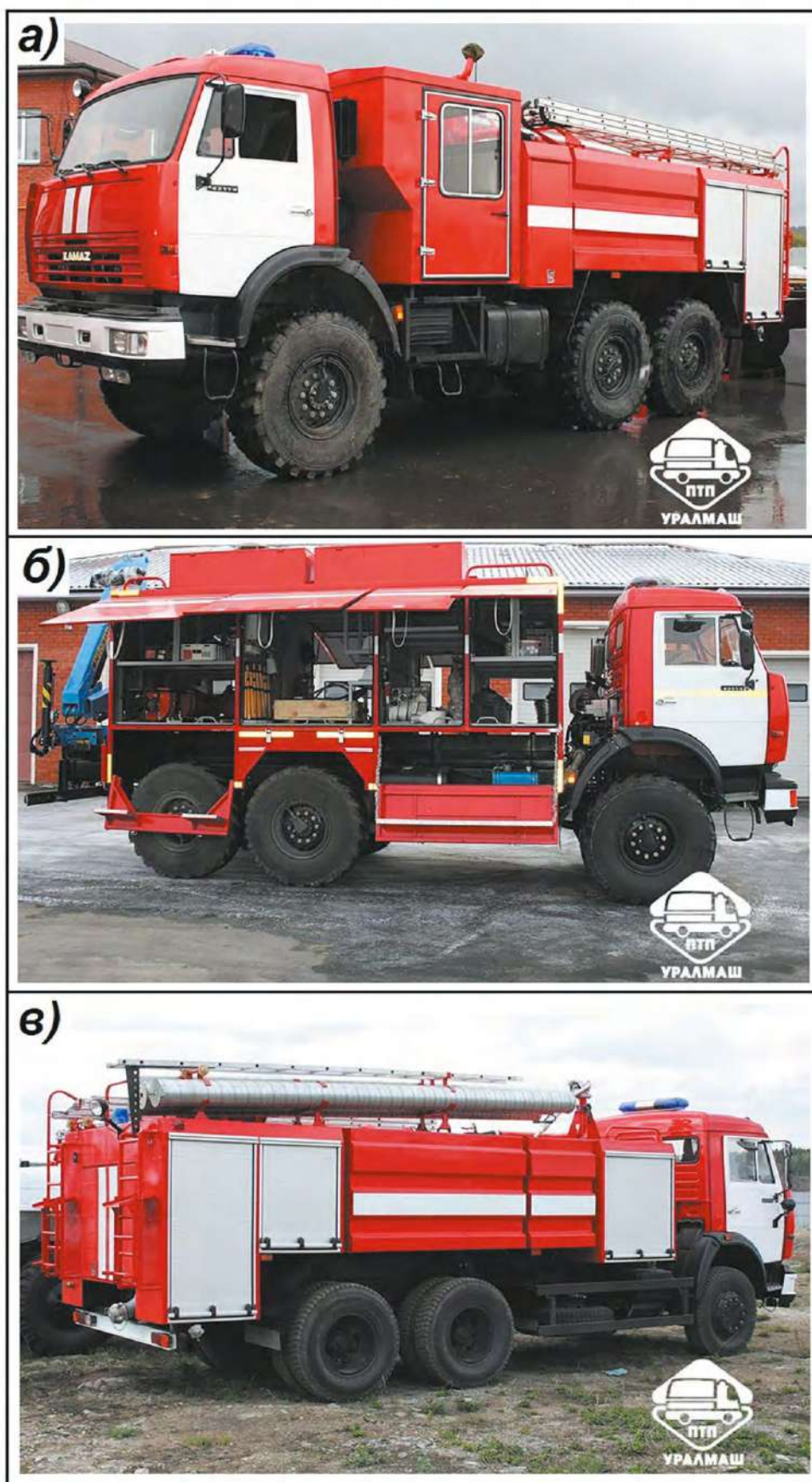
Рис. 4.26. Пожарные автомобили: а) автоцистерна пожарная АЦ-4,0-40 (КамАЗ-43114); б) аварийно-спасательный автомобиль АСА-20 (КамАЗ 43114); в) автоцистерна пожарная АЦ 9,0-40 (КамАЗ-65115) с увеличенным баком для пенного пожаротушения.
