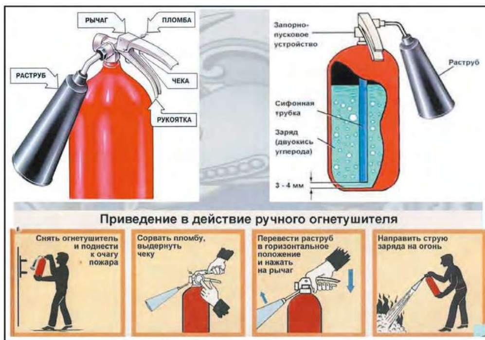
Рис. 4.21. Схема и принцип действия ручного огнетушителя.
