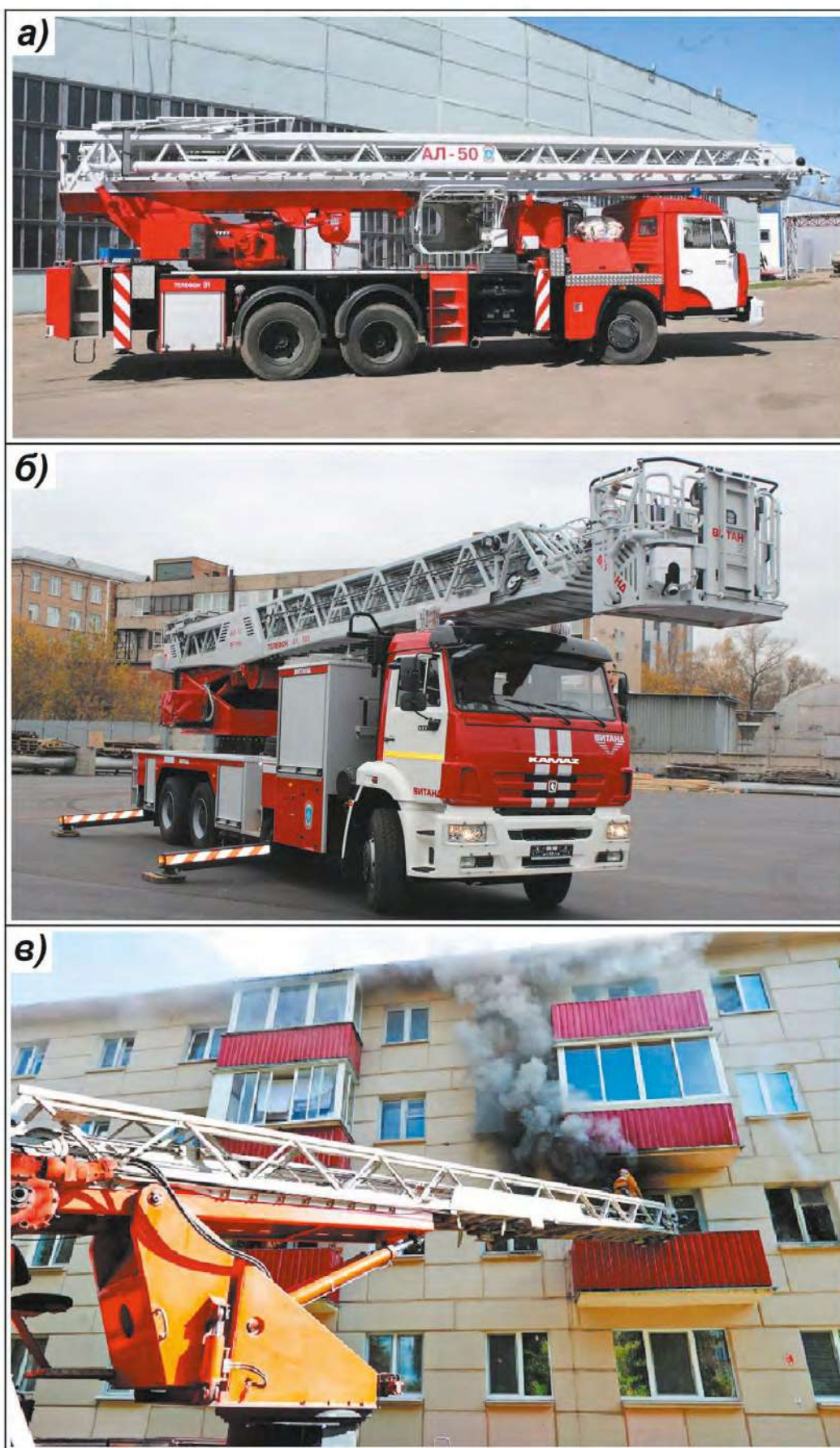
Рис. 4.27. Автомобильные лестницы пожарные: а) автолестница пожарная АЛ-50 (КамАЗ-53229); б) автолестница модели АЛ-55; в) применение автолестницы при эвакуации людей и подачи огнетушащих веществ в квартиру многоэтажного дома.
