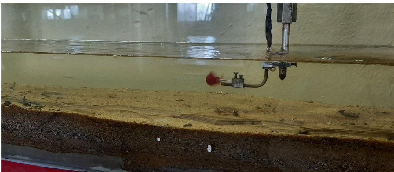
Рис. 11 –Наглядное изображение установленной в поток микровертушки
