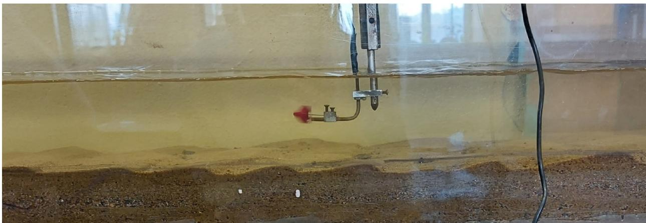
Рис. 12 – Наглядное изображение формирования грядового режима движения наносов
