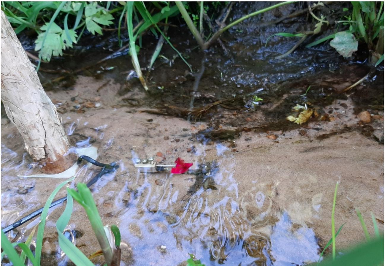
Рис. 16 – Фотография работающей вертушки, во время записи данных с подвалья гряды
