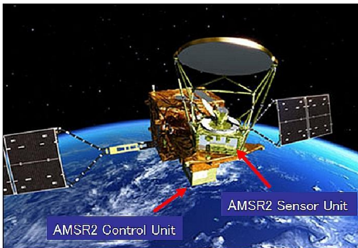
Рисунок 4 - Модули AMSR2 спутника GCOM-W1
