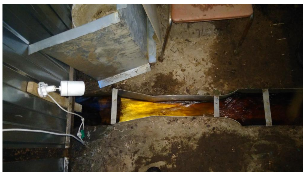
Рисунок 2.1.8 – Камера, направленная на лоток Вентури
