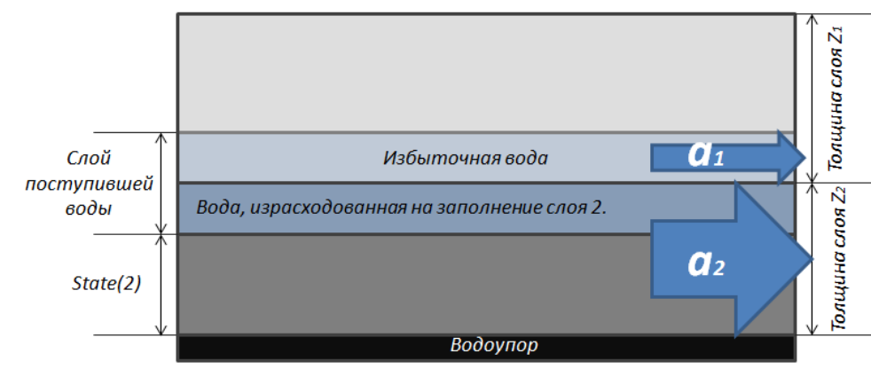
Рисунок 4.2 – Схема поведения воды на границе двух слоёв.
