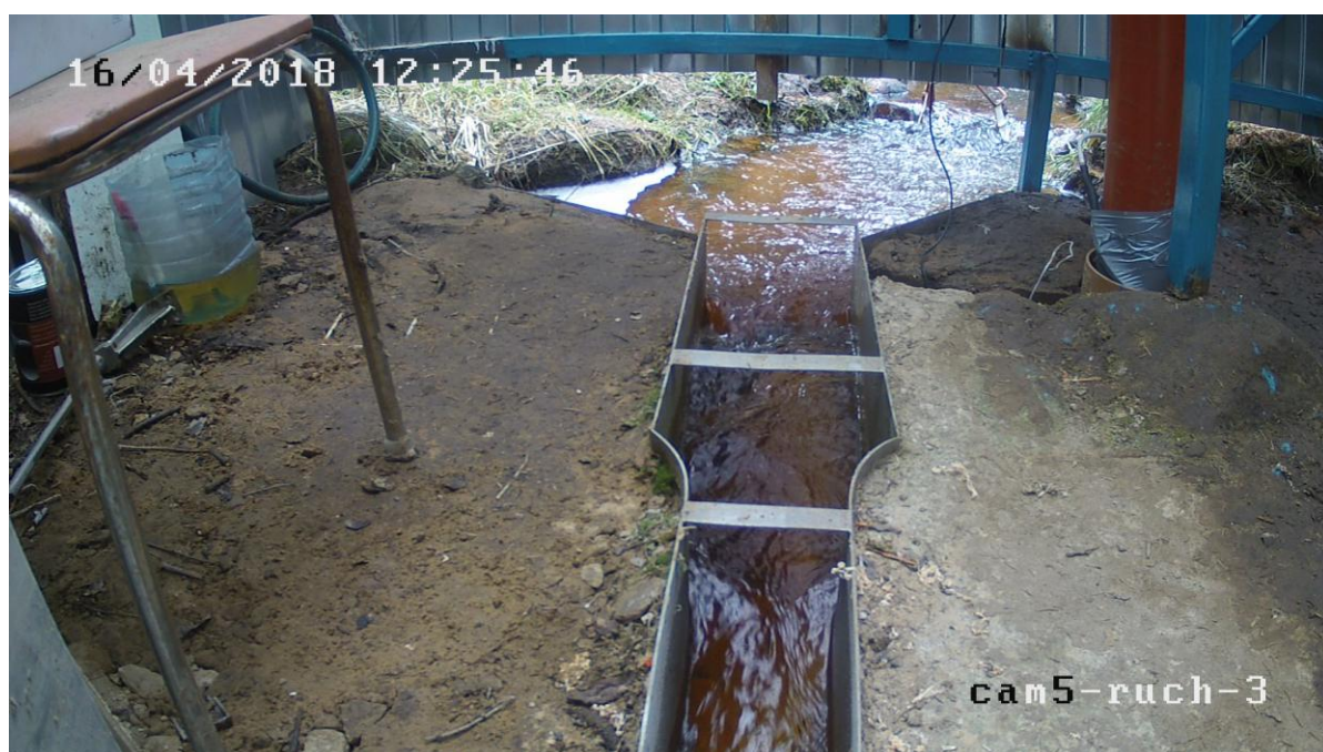
Рисунок 2.1.6 – Вид с камеры, направленной на лоток Вентури
