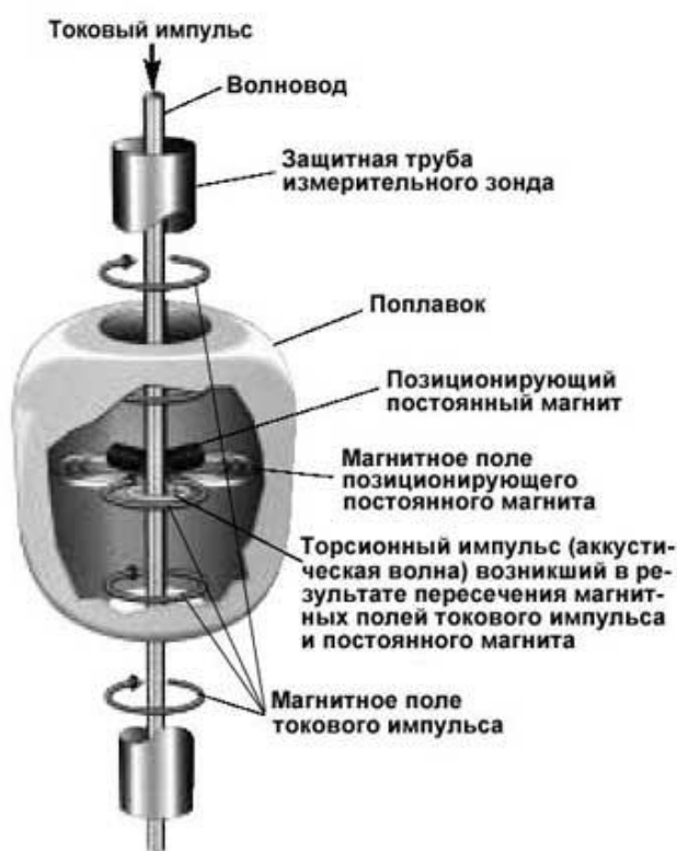
Рисунок 2.2.2.1 - Схема магнитострикционного датчика уровня воды
