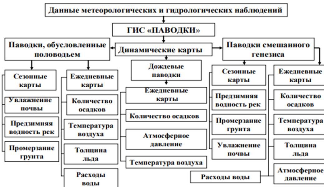
Рисунок 2.5 – Процесс получения динамических карт паводковой опасности
