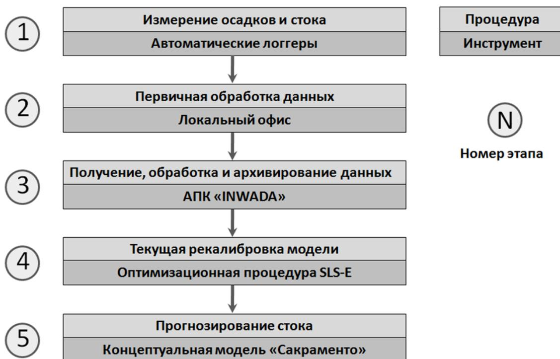
Рисунок 2.6 – Блок-схема системы ФПС, разработанной в РГГМУ
