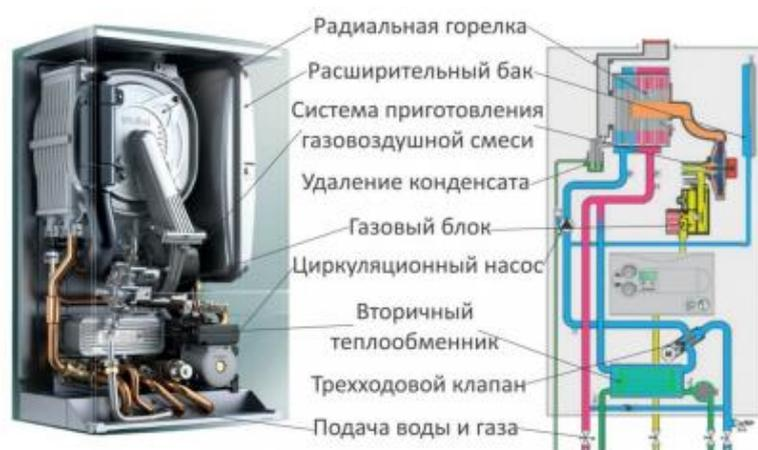
Рисунок 3 – Конструкция конденсационного газового котла.
