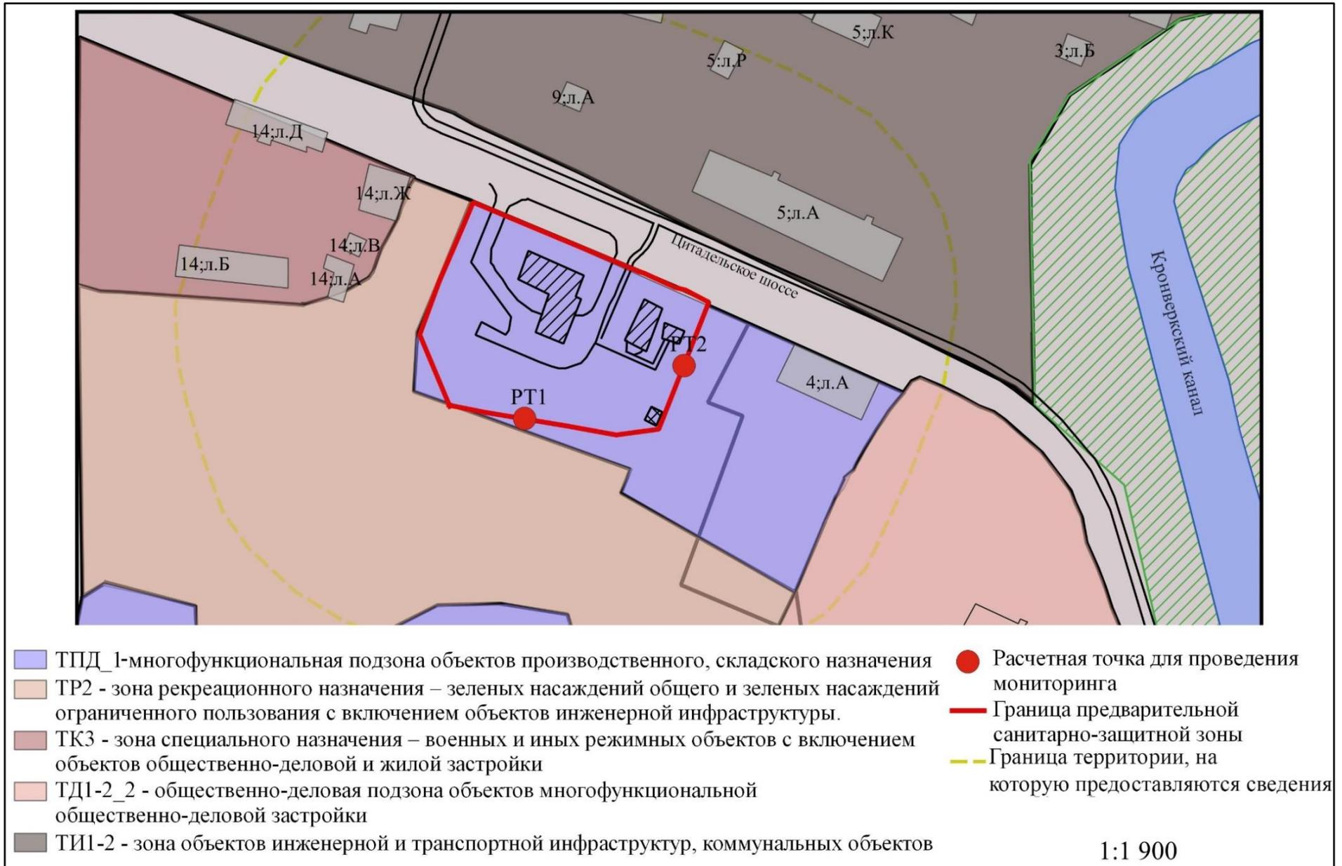
Рисунок Б.1 – Ситуационный план предварительной санитарно-защитной зоны
