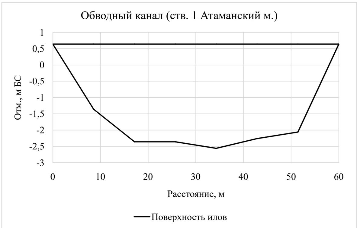
Рисунок 2.2.2 – Поперечный профиль Обводного канала в створе №1
