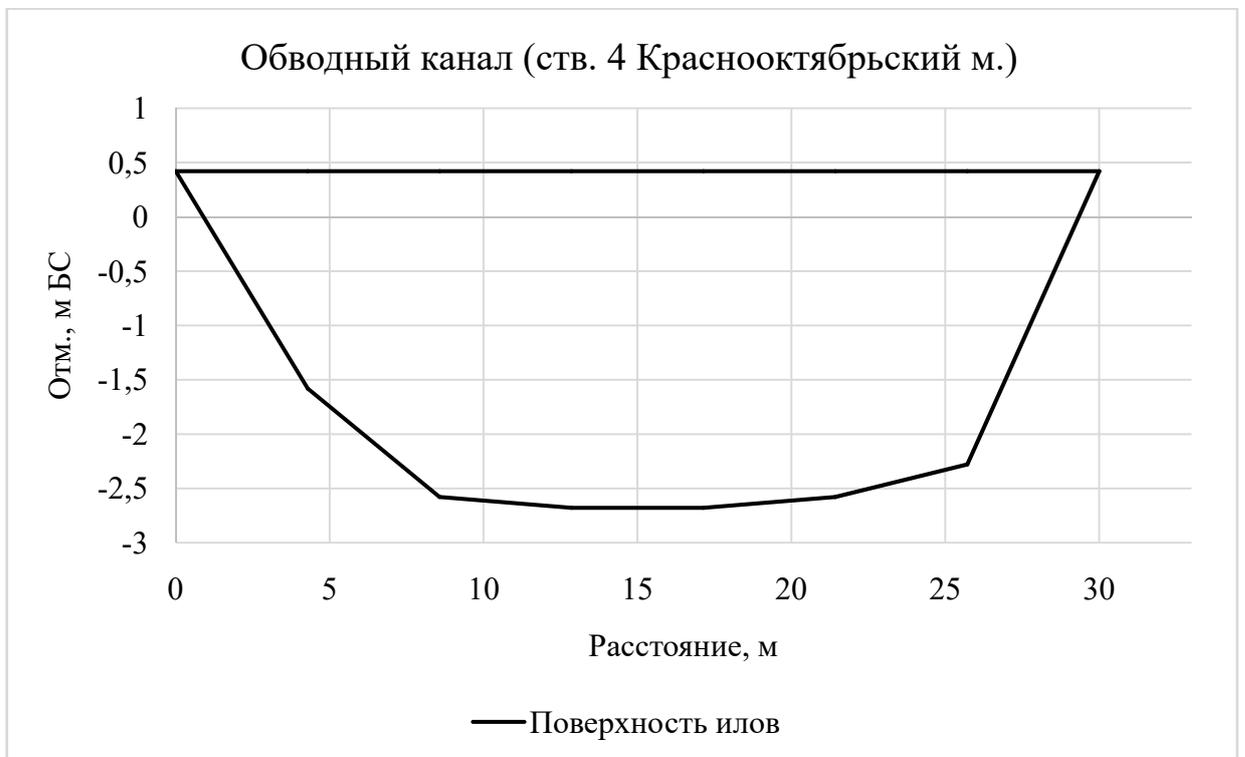
Рисунок 2.2.5 – Поперечный профиль Обводного канала в створе №4
