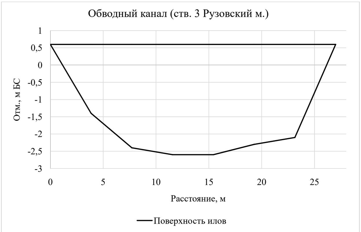
Рисунок 2.2.4 – Поперечный профиль Обводного канала в створе №3
