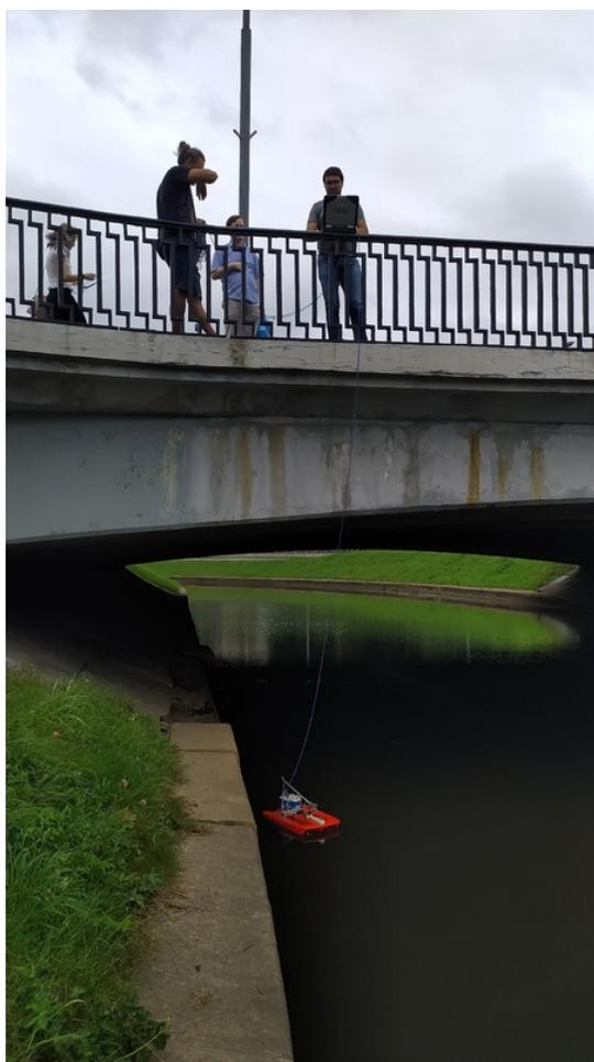
Рисунок 2.2.1 Подготовка профилографа «Stream Pro» к работе
