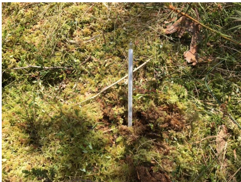
Рисунок А.8 – Измерение температуры торфа поверхностного горизонта почвенным термометром ТП-1
