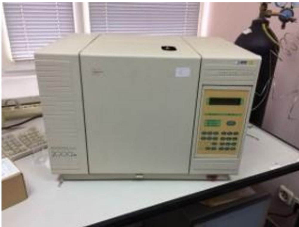
Рисунок А.5 - Газовый хроматограф Кристалл 2000М, год выпуска — 2003.
