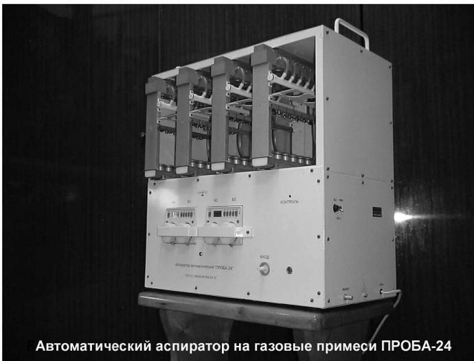
Автоматический аспиратор на газоприимные примеси ПРОВА-24
