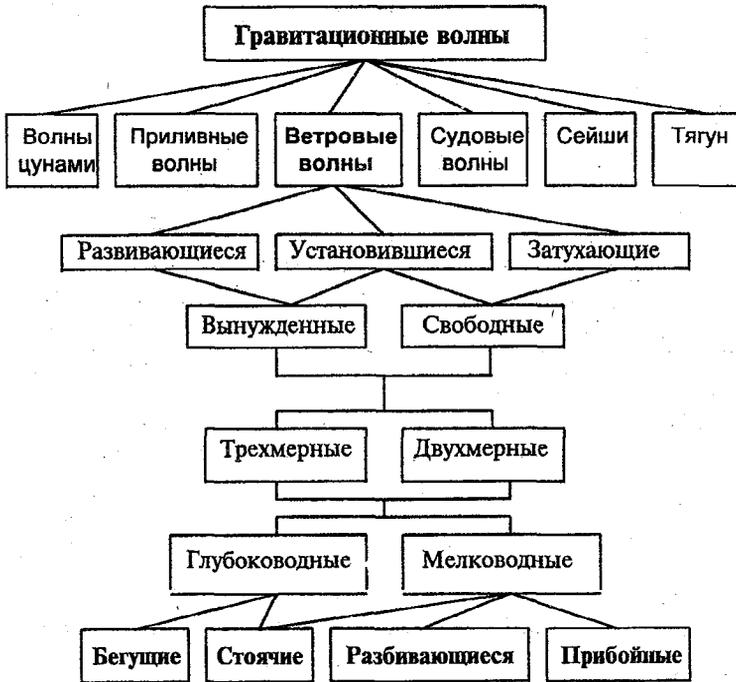
Рис. 2.1. Схема классификации гравитационных волн.
