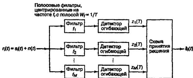
Рис. 2.9. Некогерентное детектирование сигналов FSK с использованием детекторов огибающей
