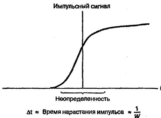
Рис. 11.2. Измерение времени задержки распространения
