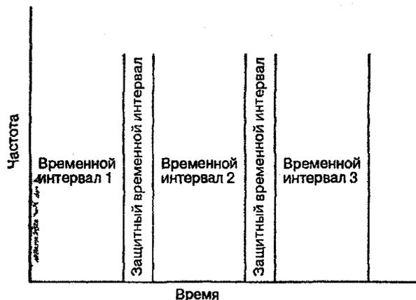
Рис. 10.6. Уплотнение с временным разделением
