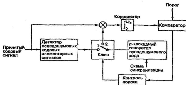
Рис. 11.14. Быстрая синхронизация путем последовательной оценки
