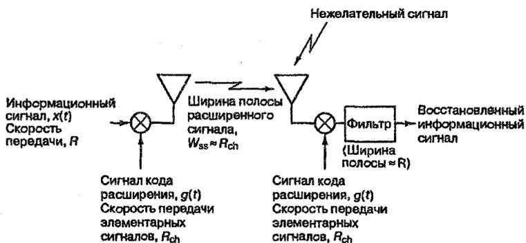
Рис. 11.3. Основа метода расширенного спектра
