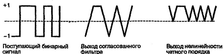
Рис. 4.6. Иллюстрация процессов, происходящих в разомкнутом битовом синхронизаторе
