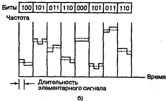
Рис. 11.11. Системы связи с использованием FH: а) FFH б) SFH
