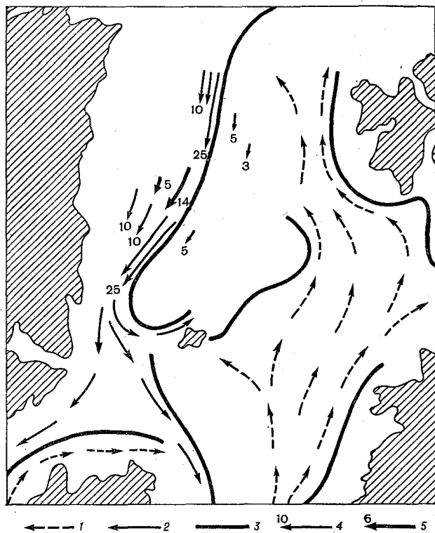
Рис. 33. Распределение основных струй теплых (1) и холодных (2) течений, положения гидрофронтов (3), векторы и скорости течений (4) и дрейфа льда (5) (см/с) по данным работ [121, 145].
