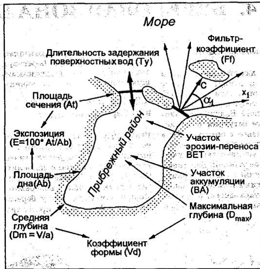
Рис. 2. Важные морфометрические параметры прибрежной зоны
