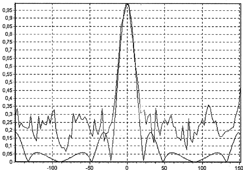
Рис.7.3. Теоретическая и экспериментальная характеристики направленности электронно-оптического приемника на частоте 27 кГц.
