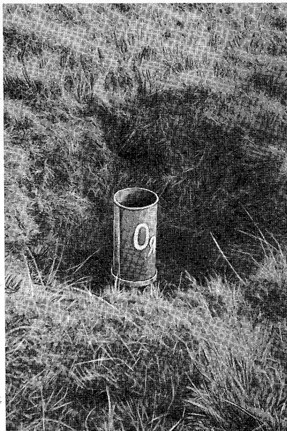
Рис. 2. Защита наземного дождемера в виде открытой сверху ямы диаметром 120 см (ямочный дождемер). Воейково.
