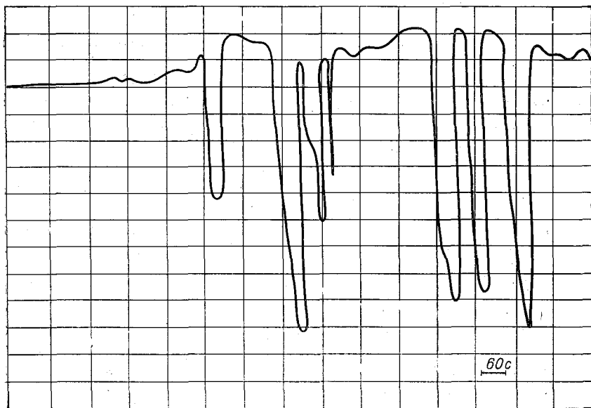
Рис. 1. Пример регистрации показаний пиранометра при кучевой облачности, установленного на актинометрической стреле в кардановом подвесе.
