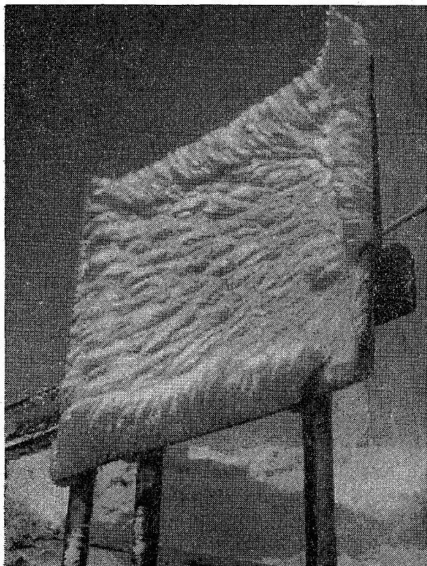
Рис. 1. Обледеневший щит размером 0,9 \times 1 м в период интенсивного нарастания зернистой изморози.
