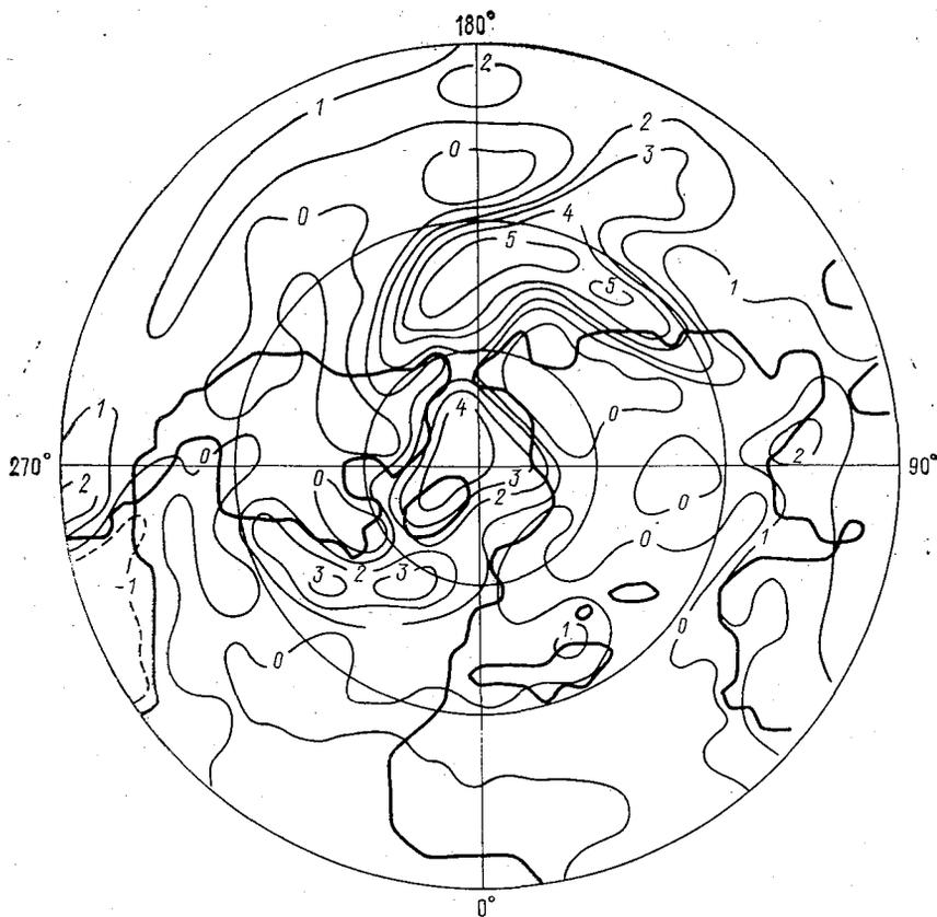
Рис. 2. Распределение разностей общей облачности (баллы) между данными экспериментов с уменьшением солнечной постоянной на 5% и контрольного для условий июля.
