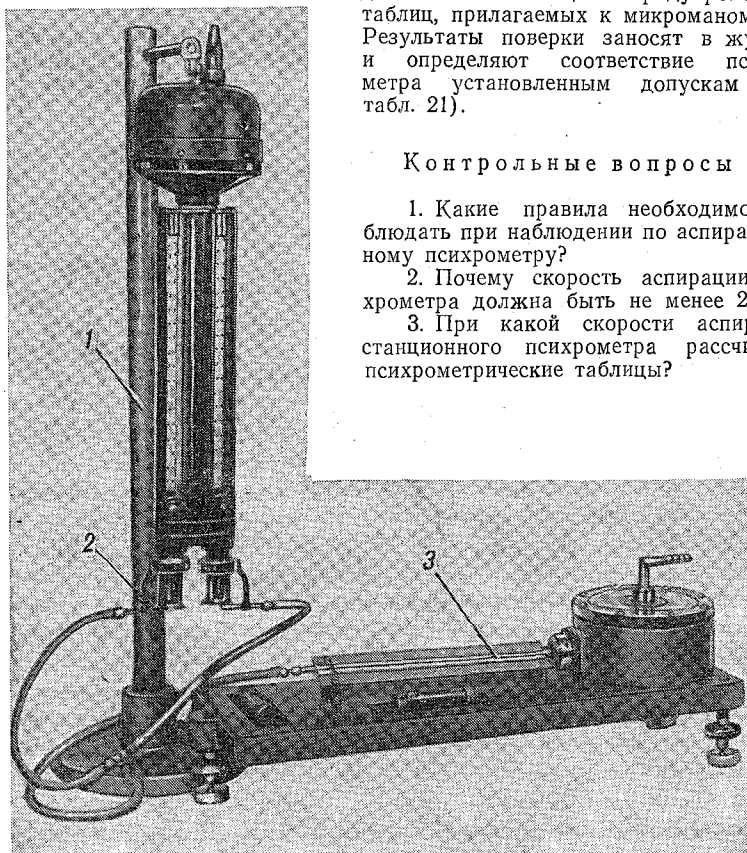
Рис. 47. Установка для поверки аспирационного психрометра ПО-30.
