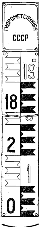
Рис. 8. Рейка водомерная постоянная металлическая эмалированная.
