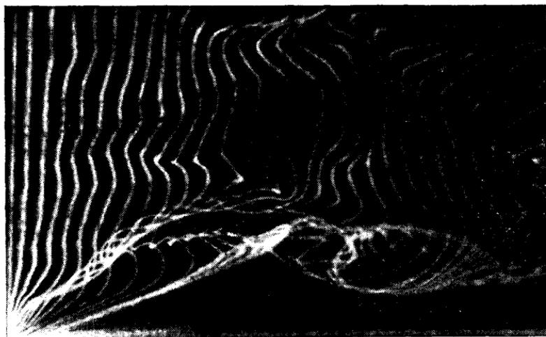
Рис. 11.8. Искривление вихрем первоначально вертикальных линий водородных пузырьков [151].
