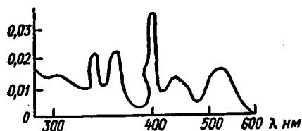
Рис. 4.3. Спектр поглощения иона [Mn(H_2O)_6]^{2+} в видимой области (ион получен в водном растворе перхлората).
