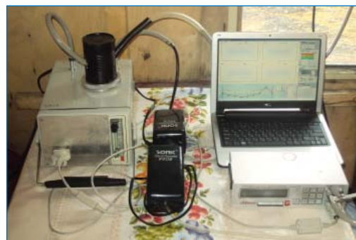
Внешний вид портативного солнечного фотометра SPM
