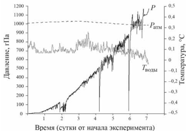
Рис. 10. Изменения температуры воды ( T_{\text{воды}} ) и гидростатического давления ( P ) в жидкой линзе и атмосферного давления ( P_{\text{атм}} )
