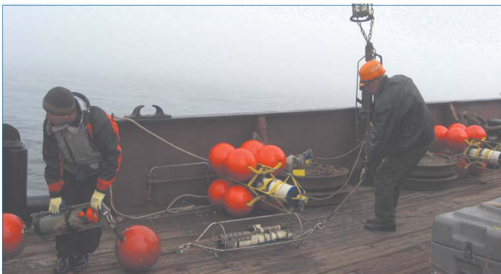
Притопленная буйковая станция (ПБС) А1-3-07
