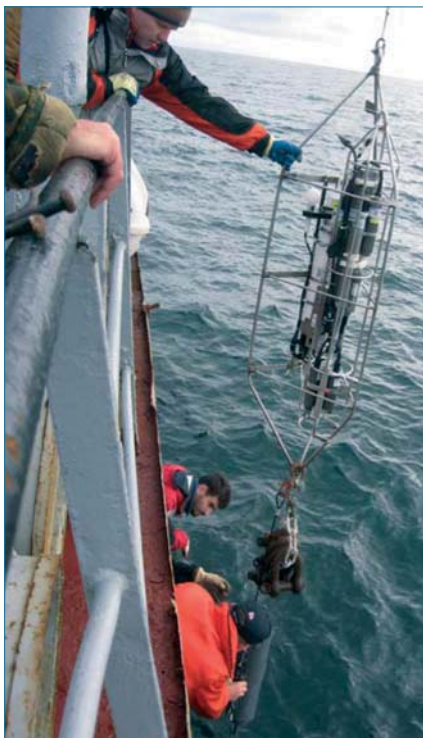
Вертикальное зондирование на океанографической станции
