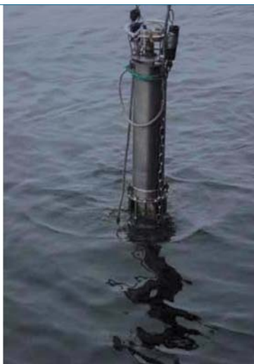
Измеритель гидрологических параметров модифицированный АЦИТ-М
