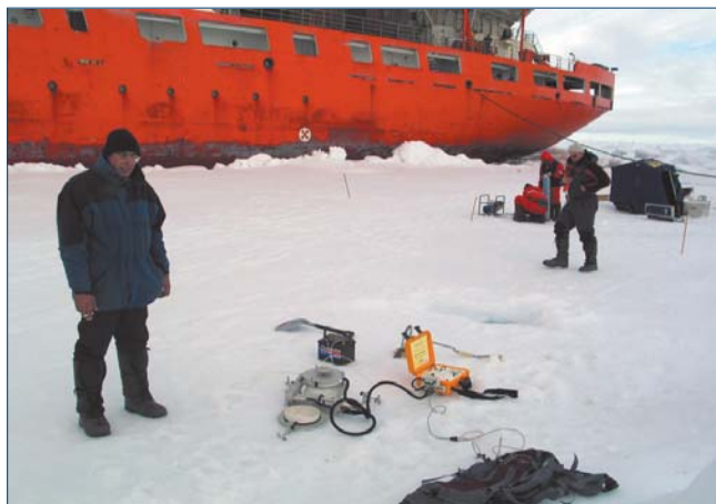
Измерение потоков \text{CO}_2 газоанализатором LI 8100. Фото П.Гребенникова
